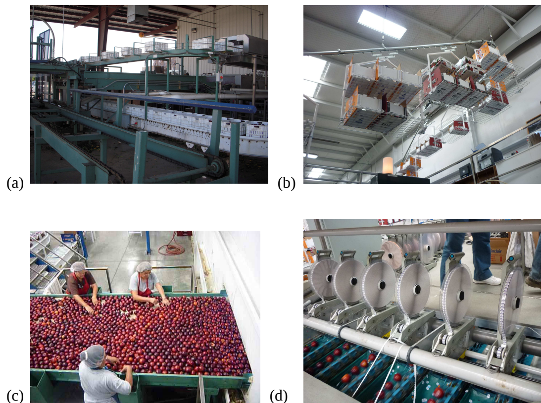
圖 10. Mountain View cold storage 公司機械化輔助分級包裝情形。(a) 同時清洗果實和採收籃的機器(b) 運送包裝箱的輸送帶(c) 圖下方選別人員將不良品丟入暗道(d)可自動貼標籤的選別機。
