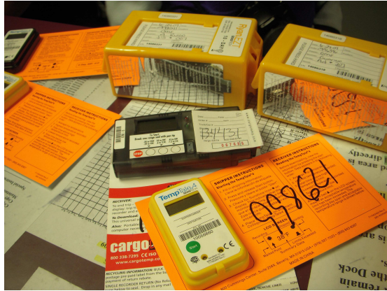
圖 4. 冷藏貨櫃車放置溫度記錄器。
