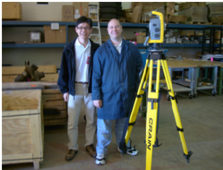
圖 2-27 TSB 近期購置之 Trimble S6 電子式全測站
