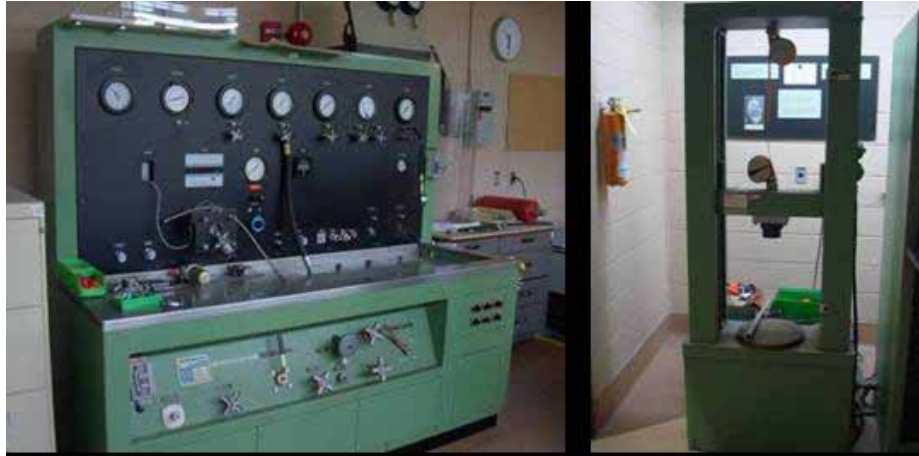
圖 2-16 氣體壓力測試平台(左)、拉力測試機(右)
