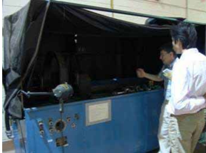
圖 2-7 利用磁力檢視殘骸裂紋之裝備
