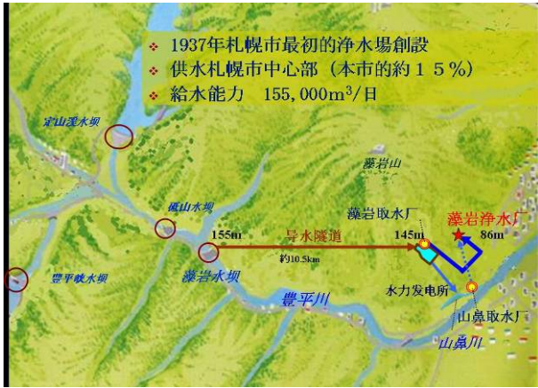
圖 10 藻岩浄水場水力發電示意
