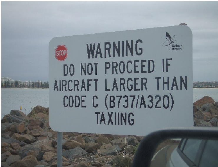
雪梨機場於滑行道與勤務車道交叉處設置指示牌規範車輛，在滑行道上有C類以上航空器滑行時應停等。
