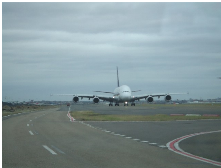
雪梨機場有部分滑行道與勤務車道之間距不足。
