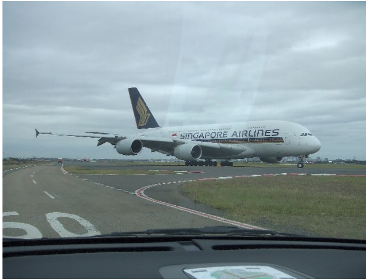
大型航空器作業時翼展範圍落於勤務車道上。
