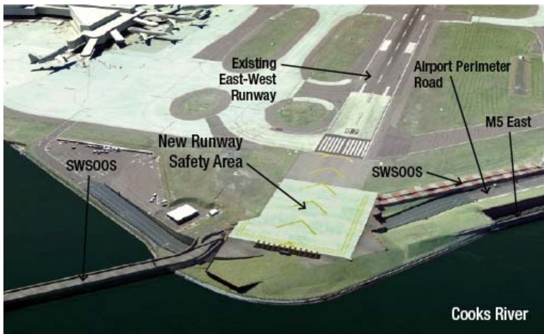
圖 8 雪梨機場 07 跑道頭前 RESA 延伸規劃圖
