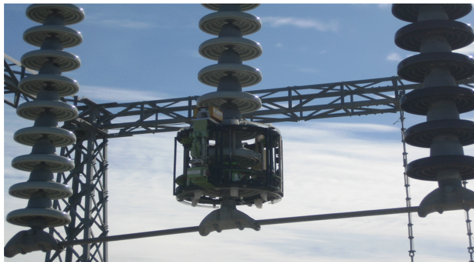
Fig. 22 Suspension String Type 機器人清洗情形
