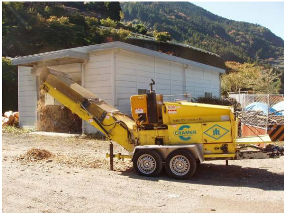
圖 2-20 漂流木顎碎機(日處理量 5 立方公尺漂流木)
