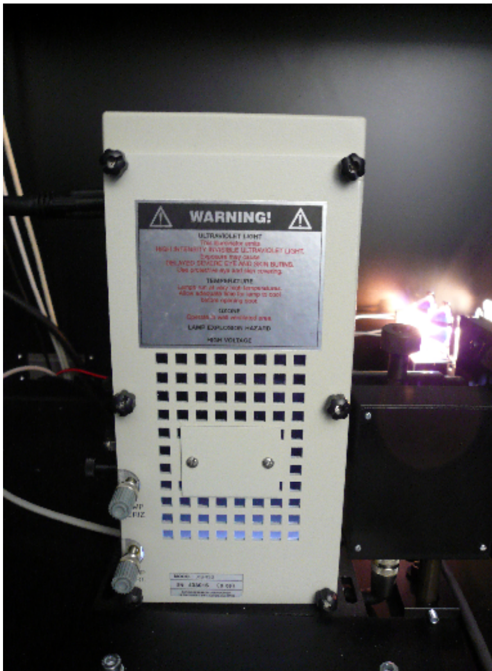
圖 11、Spectrum Response 使用之短弧氙燈光源系統
