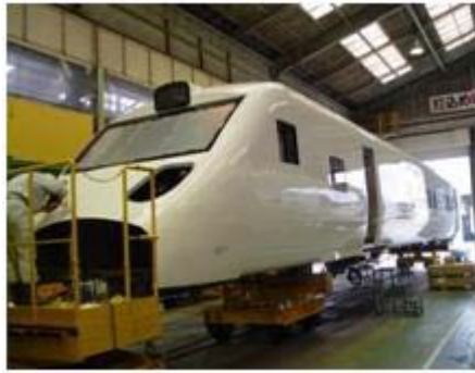
圖 6-7 鋁合金車體製造
