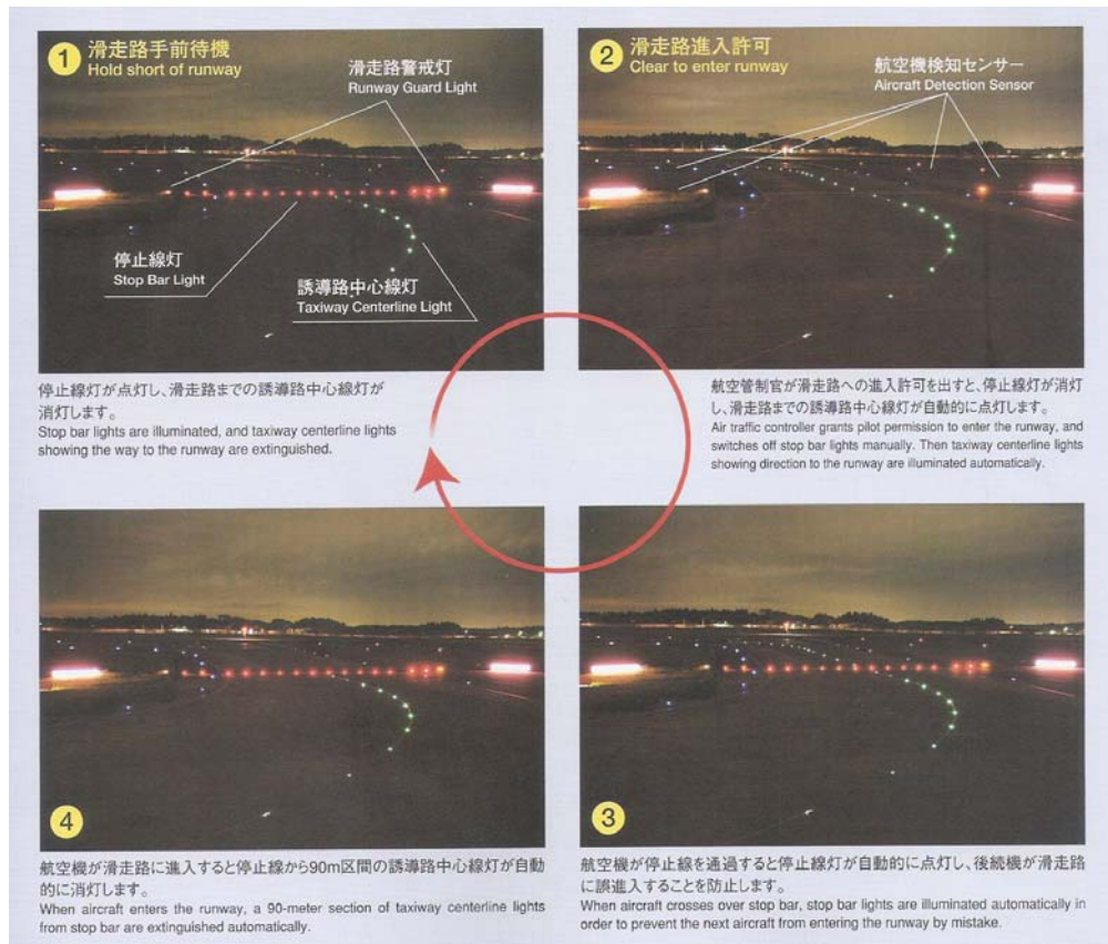
圖 3.3.12 東京成田機場的停止線燈系統
