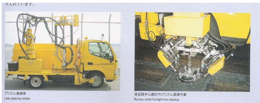
圖 3.3.15 埋入型燈光系統燈罩清洗車
