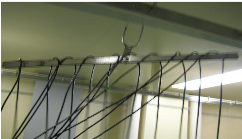
圖六；熱原感應線圈天花板移動式懸掛架
