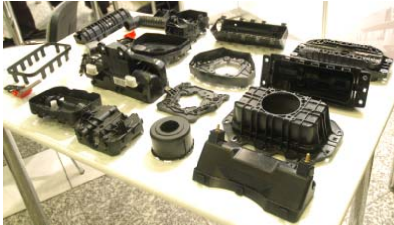
附圖十一 射出成形的氣囊零組件
