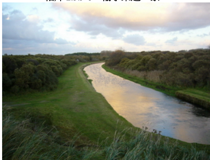
相片 2.3.9-9 出滲渠道一景(有較低高程，俾利系統以重力方式運作)
