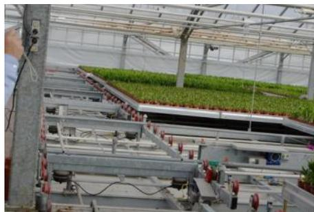
照片 64、自動化移床設備
