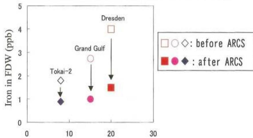
圖 5. 已安裝 ARCS 的電廠及其飼水鐵降低效果
