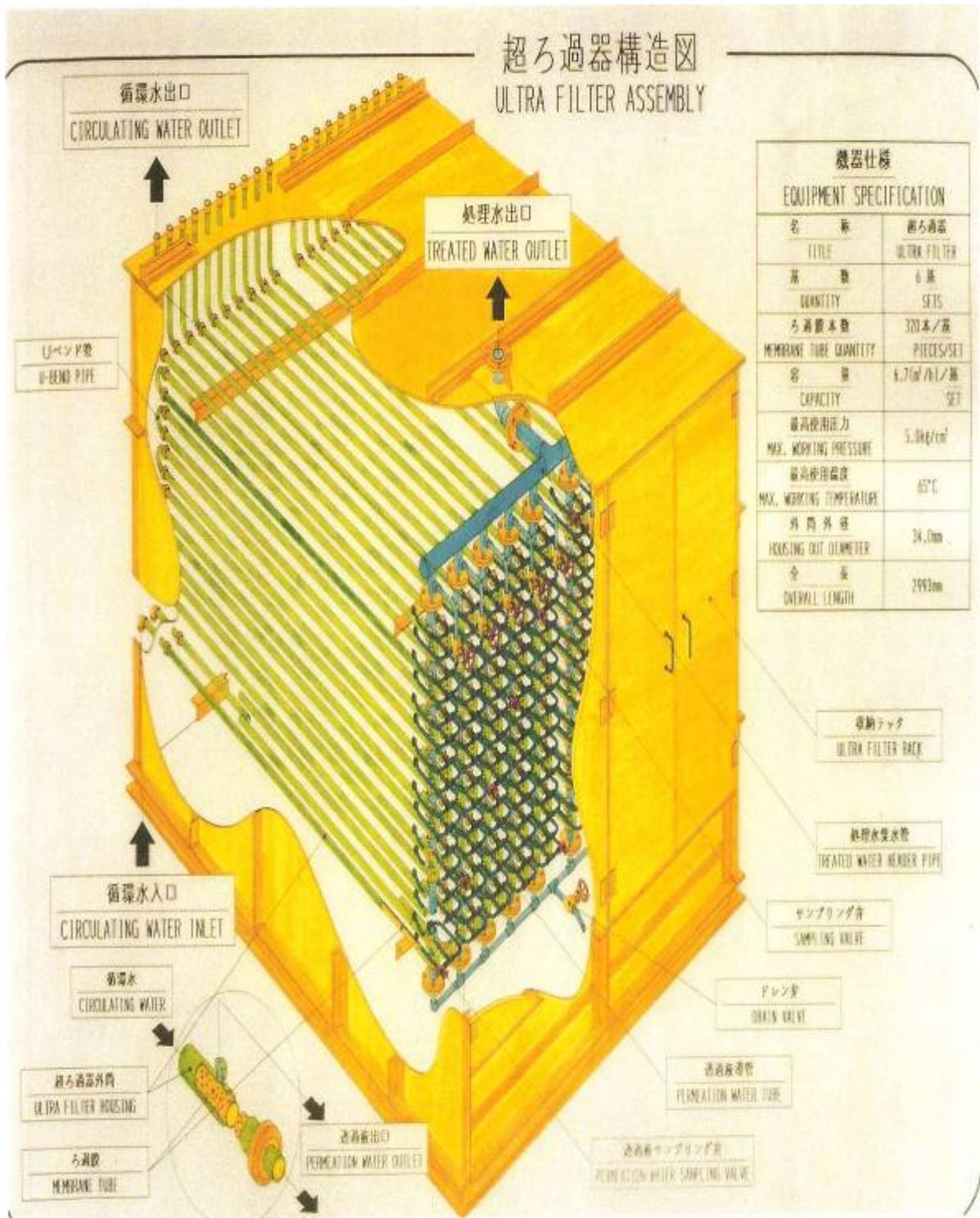
圖 15.UF 構造
