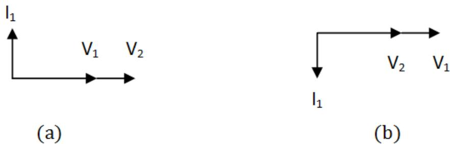
圖 2.14 STATCOM 之向量圖(a) 電容性運轉模式,  $Q > 0; P = 0$  (b) 電感性運轉模式,  $Q < 0; P = 0$
