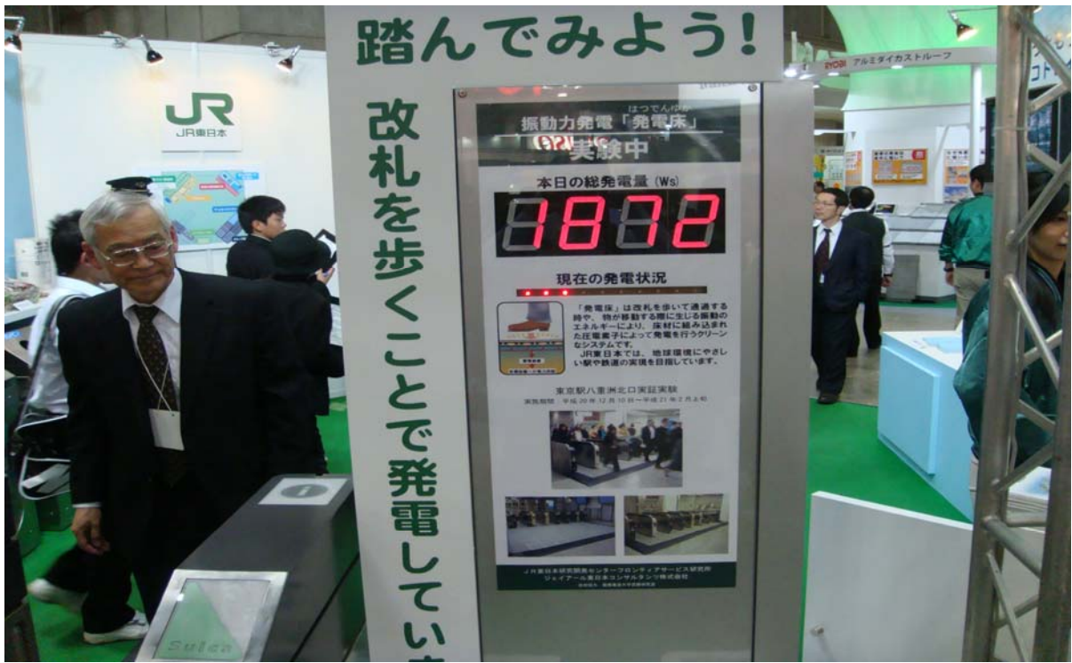
圖十五 靠車站進出人潮踩踏踏板產生電力之新發明裝置
