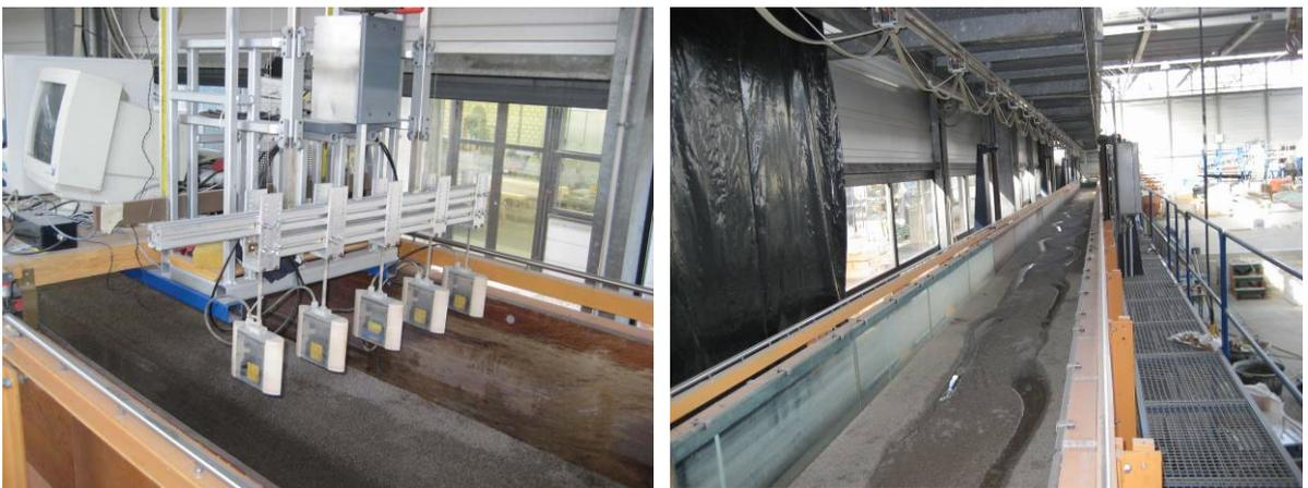
圖 2-3 實驗室河川蜿蜒型態長渠道水工模型及水位量測設備
