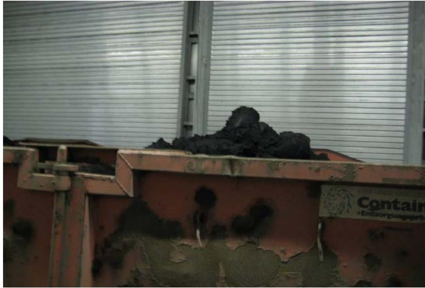
圖 7-4 污水處理場污泥處理後可供農業植栽利用
