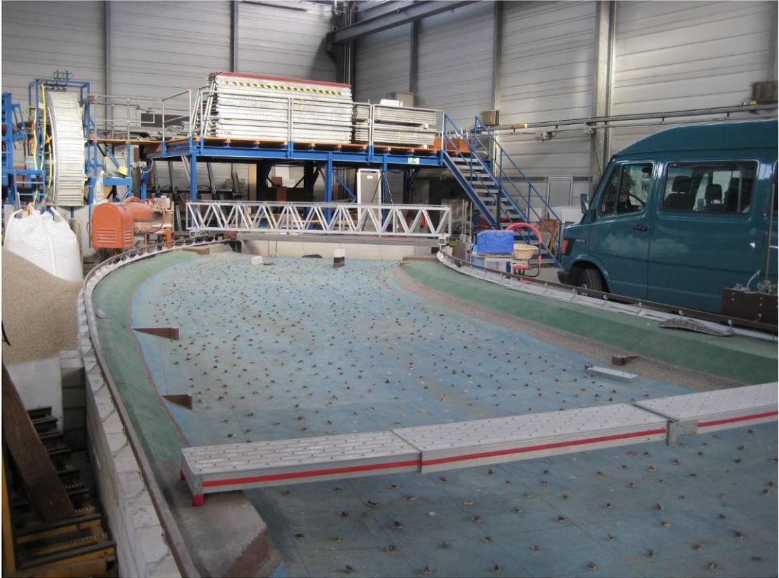
圖 2-2 實驗室萊茵河設施水理試驗水工模型
