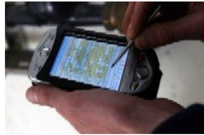
(1) AVIZ'EAU®系統 - 以 VHF 天線接收用水資訊傳至手持機接收
