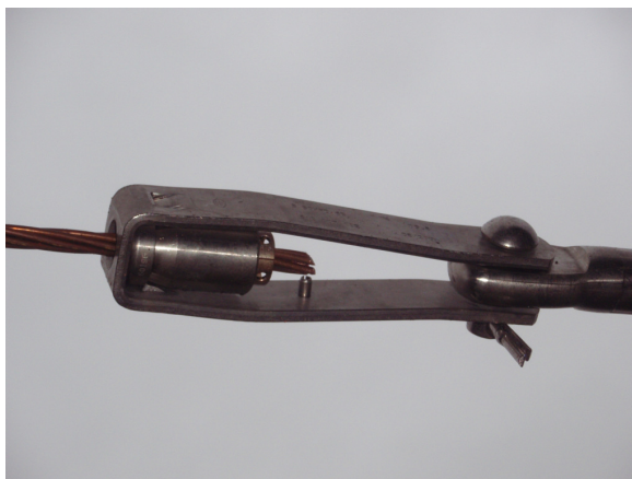
照片 5 主吊線快速尾夾
