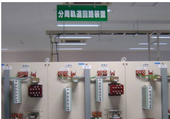
圖36 測試中的分周軌道回路
