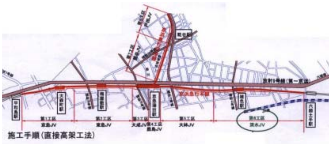
京浜急行本線在平和島站與六郷土手站間的 5.4km 採直接高架工法施工
