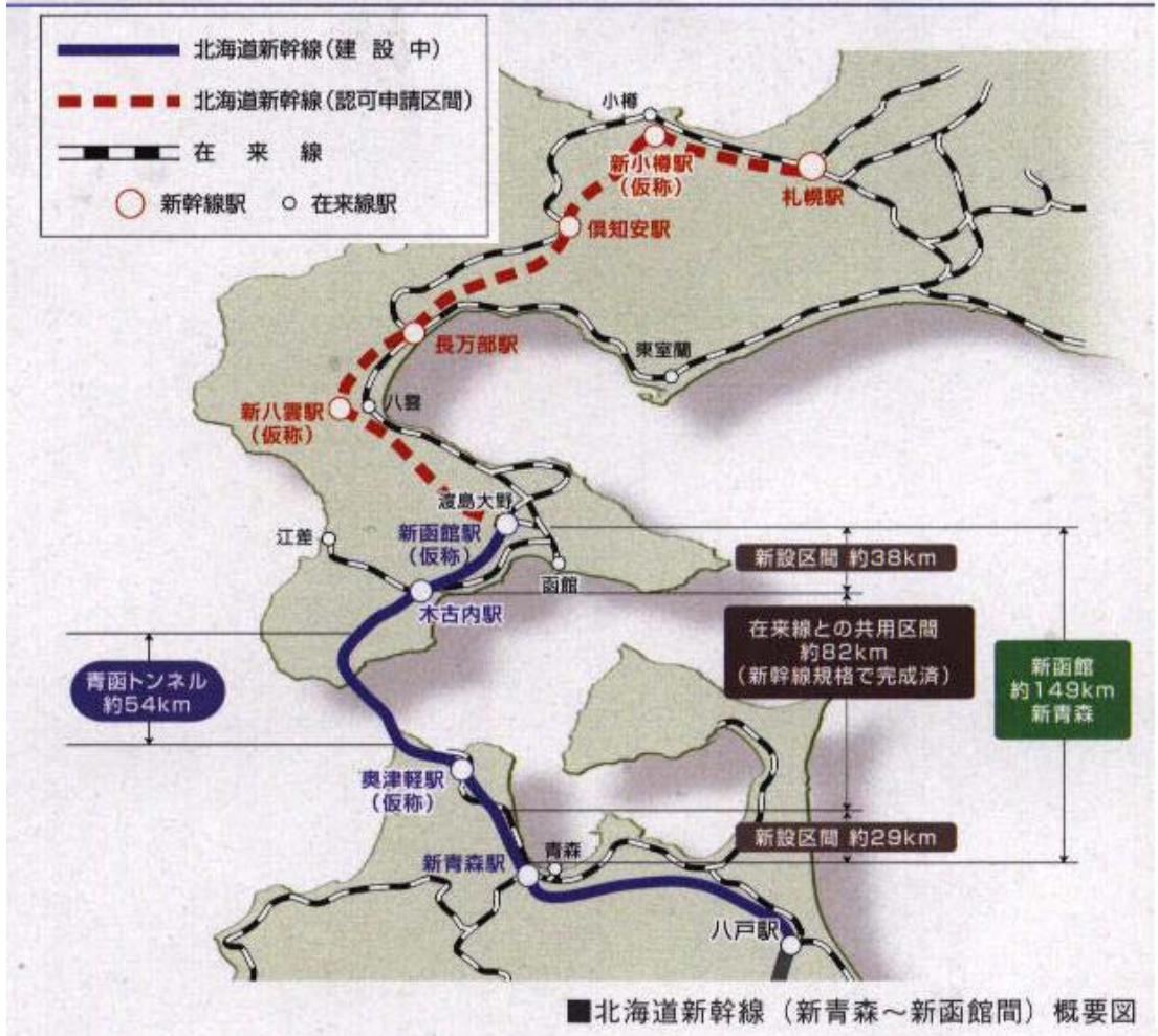
北海道新幹線從新青森~新函館間 149km 施作三軌工程範圍示意圖[3]
