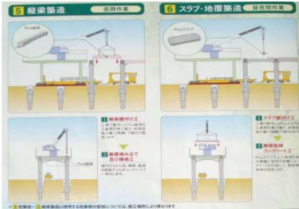
鐵路高架工法施工步驟 5、6
