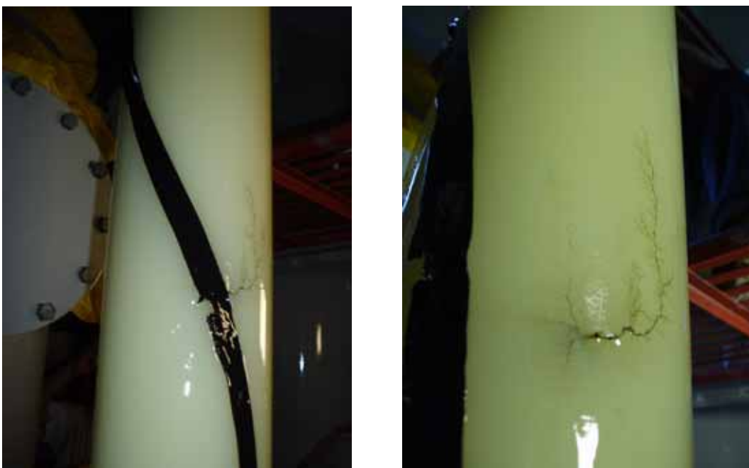
圖 5.3 絕緣層發生部分放電時電樹現象
