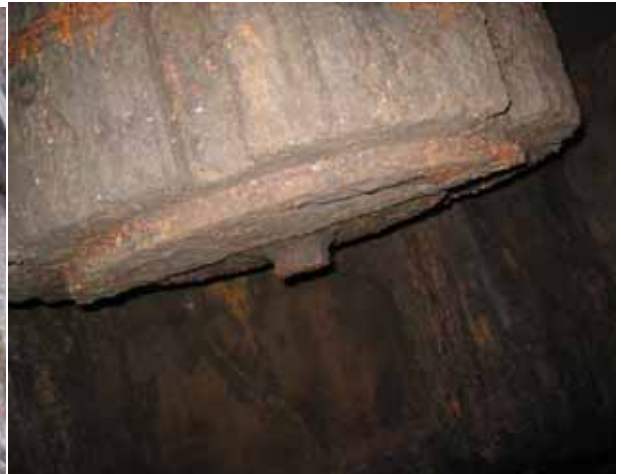
船舵固定螺栓(檢視圓孔 O.D.=300mm)
