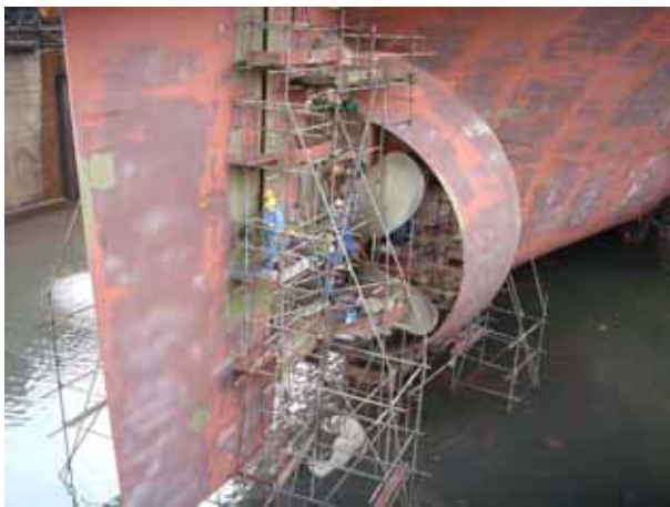
艙軸工作及舵板開孔檢查
