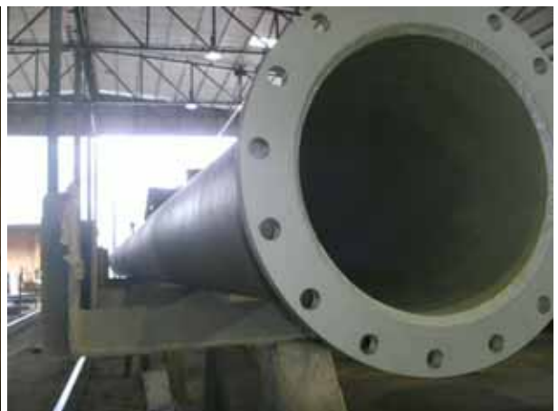
新製管路噴砂油漆檢查(400A)
