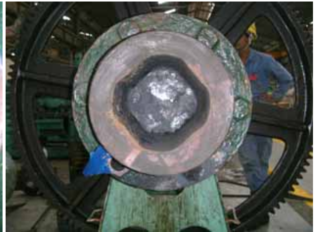
Shaft 連結孔已經擴大
