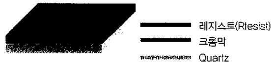
Binary 블랭크 마스크는 금속막이 차광막과 반사방지막으로 이루어져 있고, 차광막은 금속 타겟(Target)에 주로 크롬(Cr)이 사용되어 일정한 두께의 박막을 형성한다. 또한 반사방지막은 크롬의 금속 타겟에 아르곤 가스와 반응성 가스로 산소를 혼합하여 제조된다. 증착된 금속막 위에 전자빔 레지스트(E-Beam Resist) 또는 포토레지스트(Photo Resist)를 도포하면 Binary 블랭크 마스크 제작이 완성된다.
