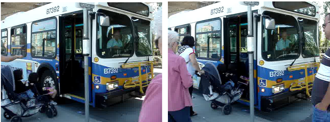
圖十九 公車氣壓式懸吊系統升降前後
