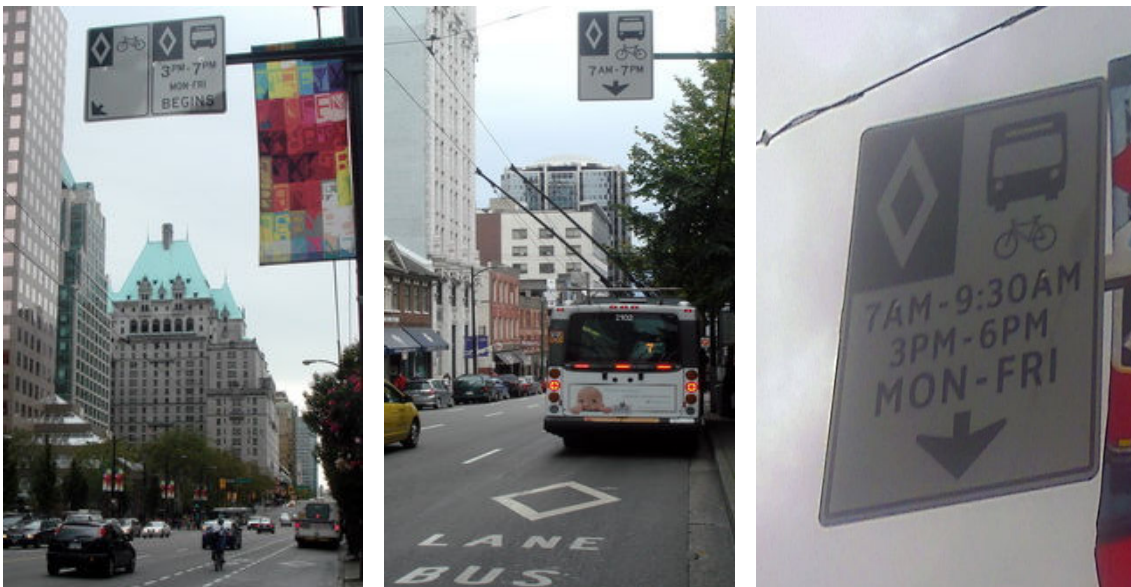
圖廿五 不同時段的公車道或公車與自行車混合車道
