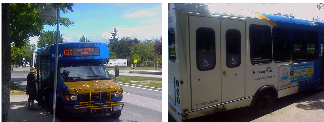
圖十 小型社區接駁公車 (前有自行車架, 右後有輪椅升降設施)
