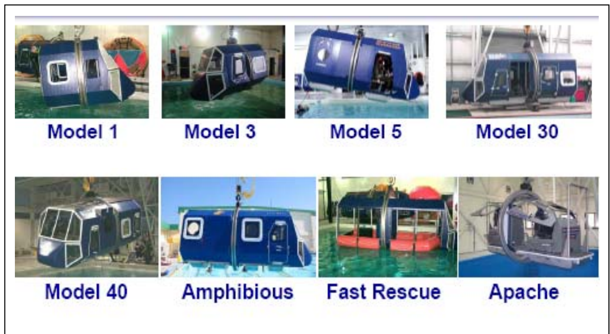
圖 3 SSTL 公司水中棄艙求生訓練模擬器
