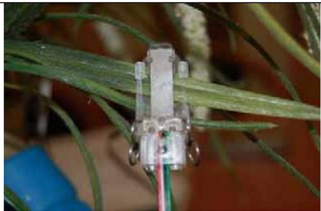
圖 24 Leaf-Sen 葉片水勢監測感測器
