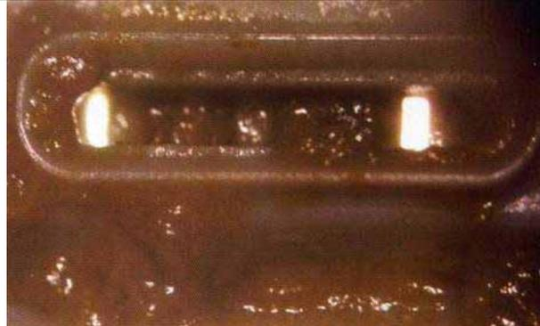
圖 6. 使用排泄水時 Inbar 滴頭入口過濾器部分堵塞之情形，其仍能有額定之流率
