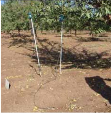
圖 19 滴灌設備結合感應器及無線發報系統連接電腦，行成自動化滴灌系統
