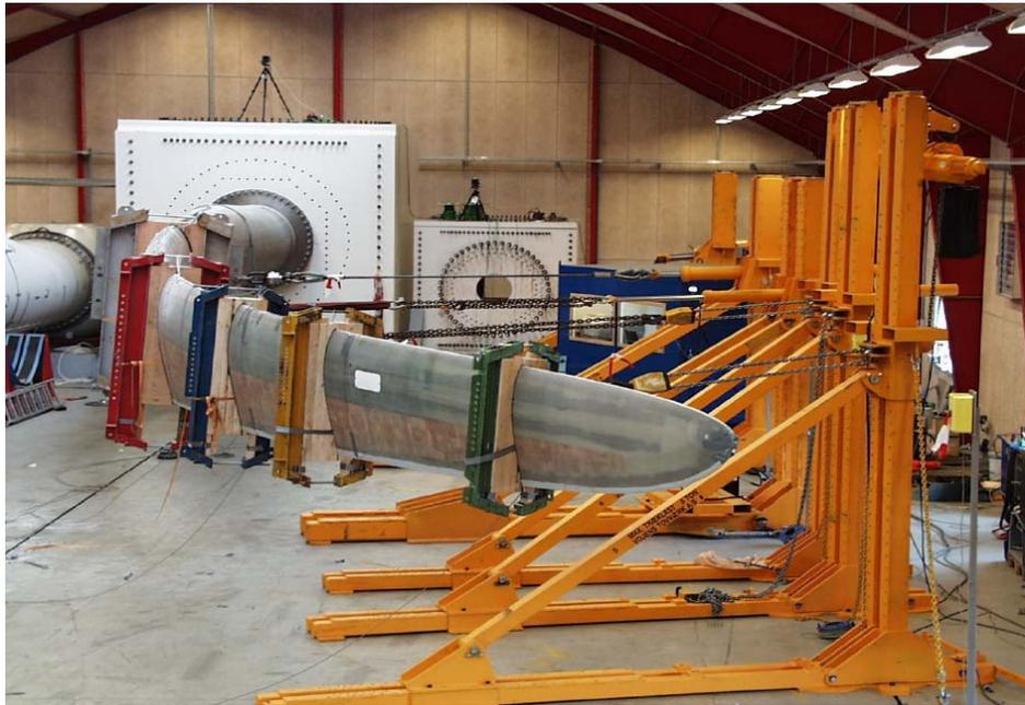
圖 26 葉片試驗情形
