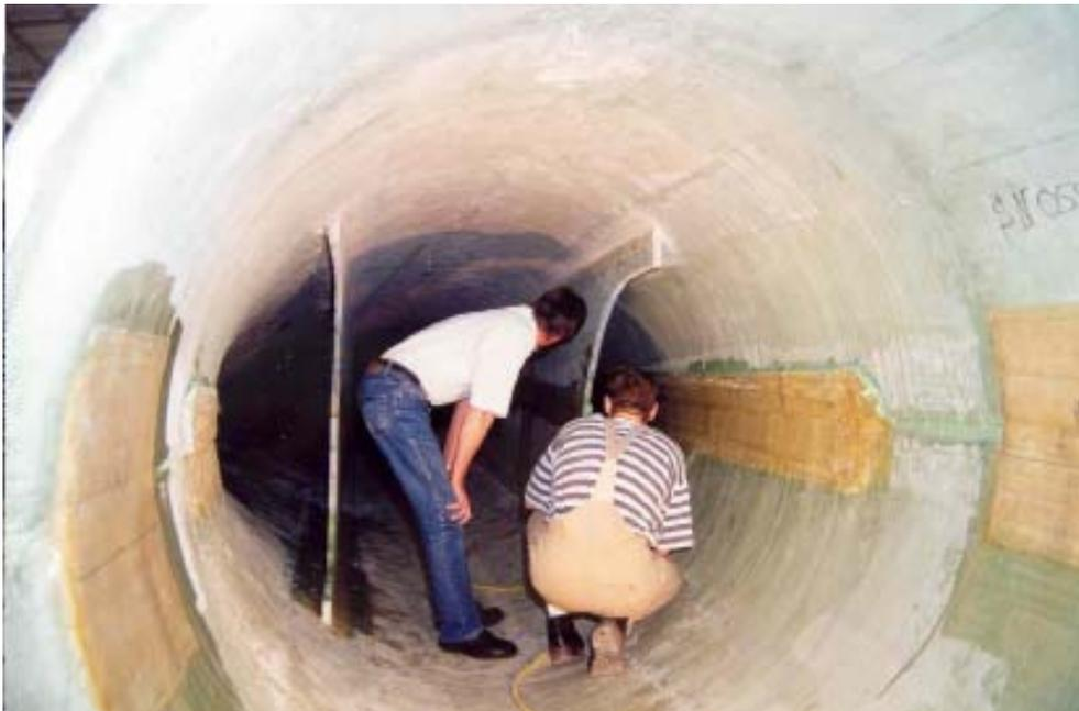
圖 60 1.5MW 風力發電機葉片內部檢測
