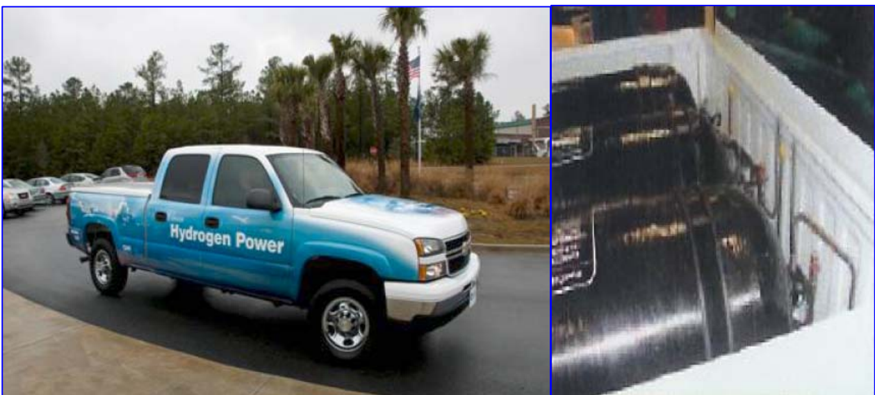
圖 2：SRNL 展示與 TOYOTA 合作研發的氫能汽車及氫氣儲存裝置(Web Material)
