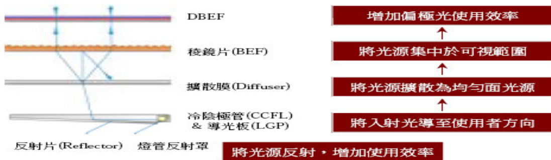
圖 2.4 背光模組個零組件功能示意圖
