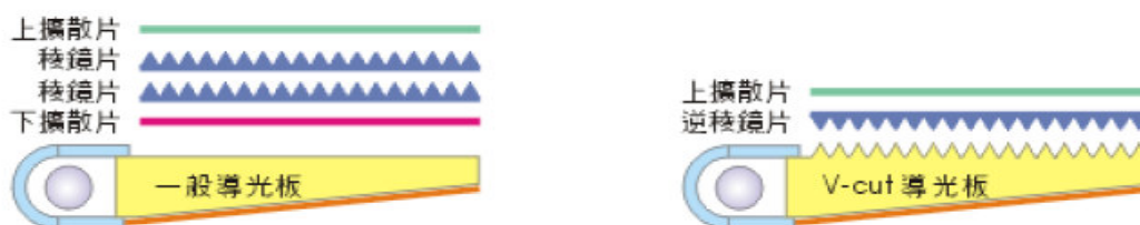
圖 2.18 傳統背光模組及 V-Cut 背光模組結構
