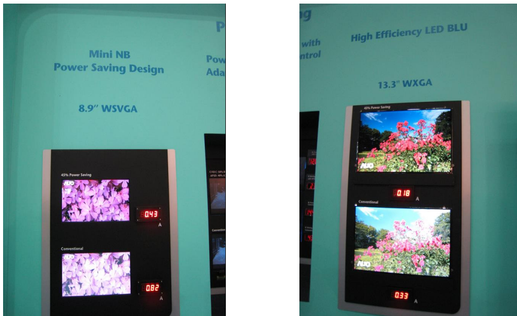
圖 2.9 友達採 CCFL 及 LED 背光源之節能比較
