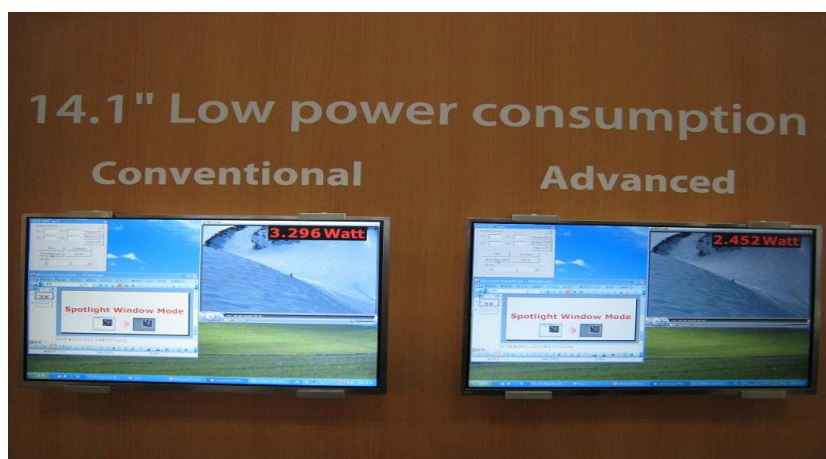
圖 2.8 LG Display 採 CCFL 及 LED 背光源之節能比較
