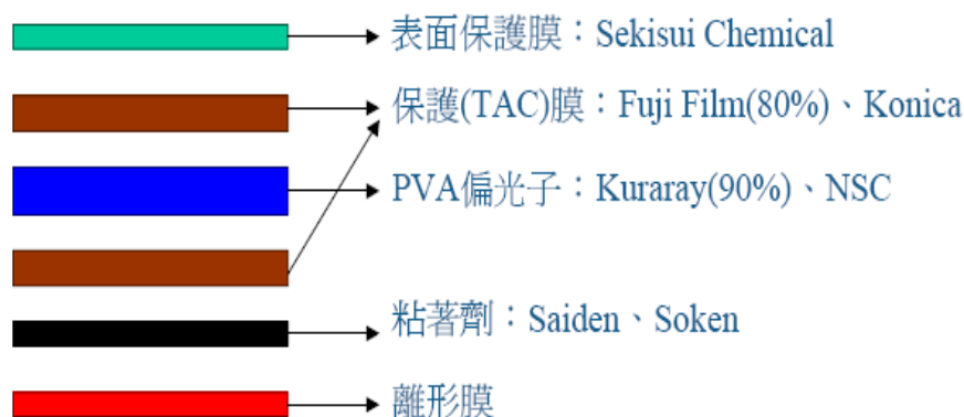
圖 1.2 偏光板結構示意圖
