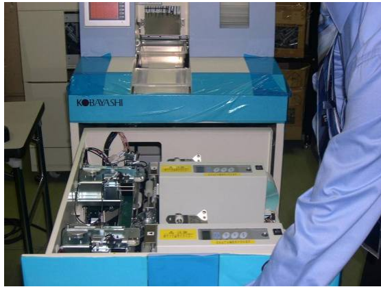
標準型備管機內的三部 Barcode Printer
