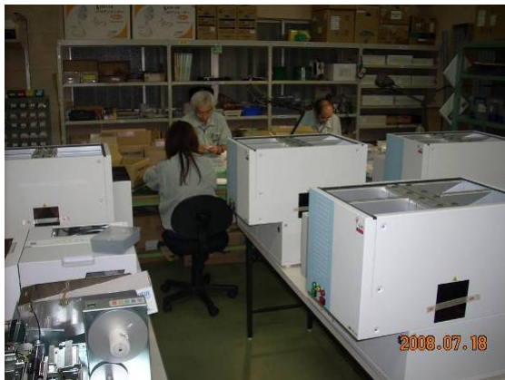
工廠一隅，前方為組裝中的桌上型備管
