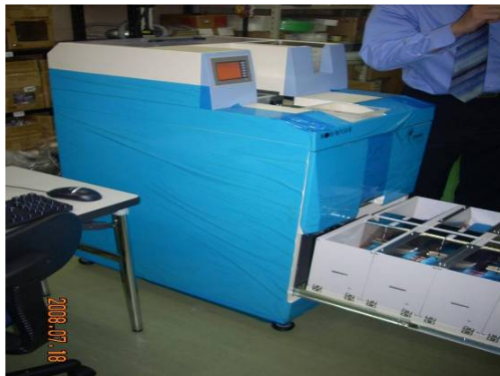
可放八種試管的試管抽屜
