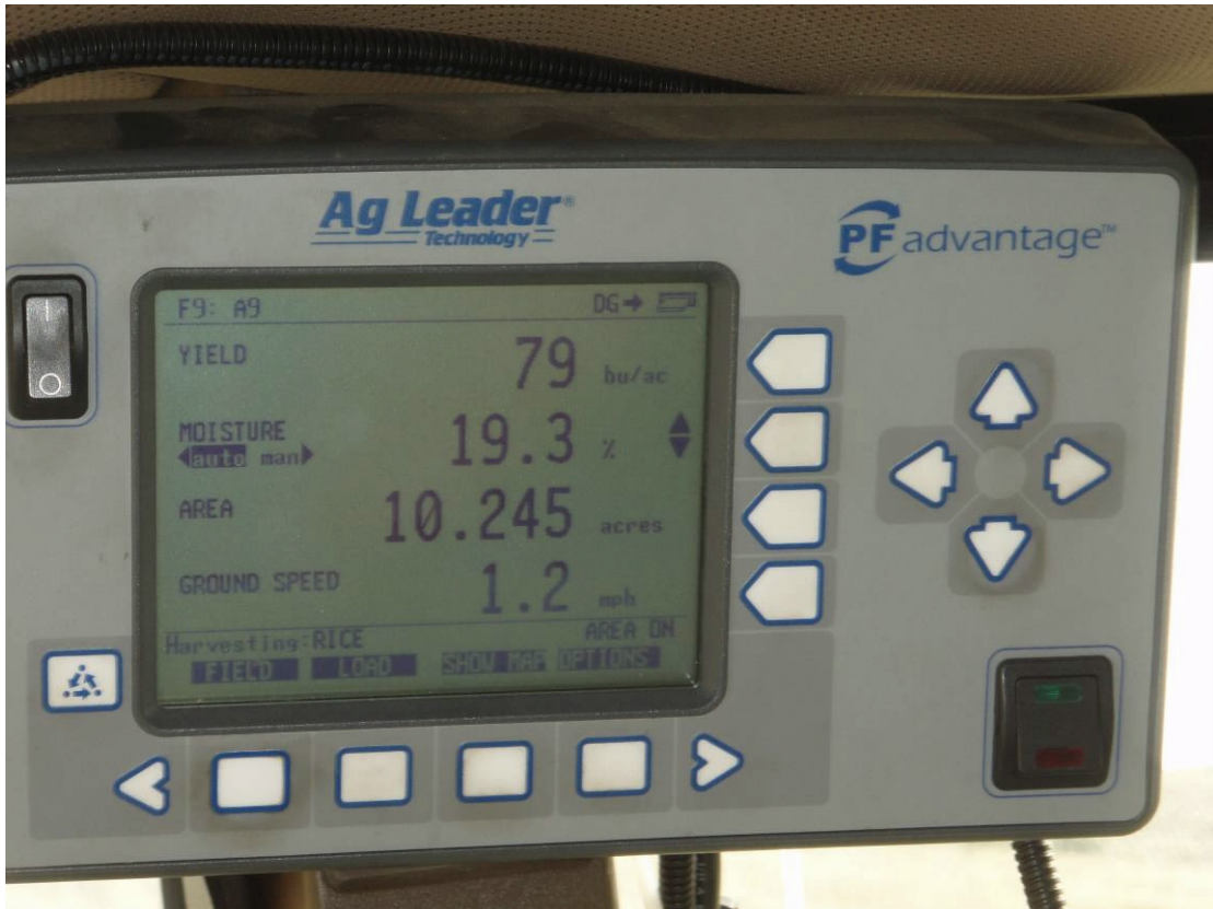
稻米收穫機上附有檢測儀器可時估測單位面積產量及稻穀水分含量
