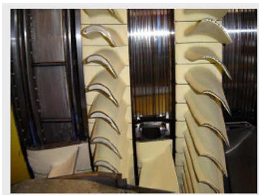
圖 10 SIEMENS V84.2 – Si3D 組裝葉片外觀
