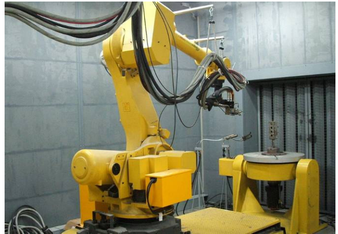
圖 6 大氣噴鋅設備
