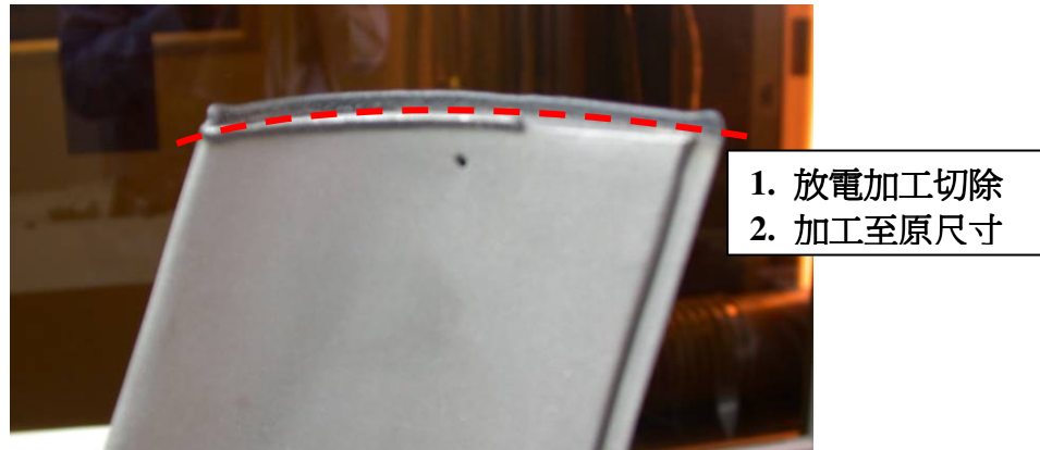
圖 2 動葉片頂端雷射鋁補
