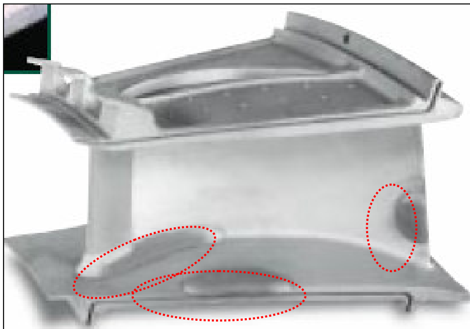
圖 18 LPM 修補完成後葉片外觀
