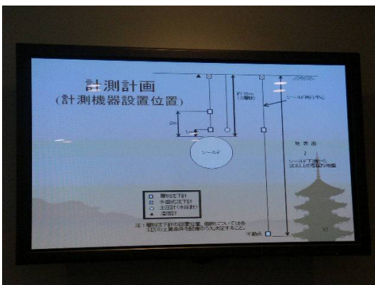
潛盾工法計測儀器設置位置
