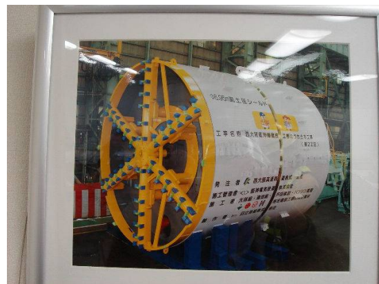
西大阪線使用的泥土壓式潛盾機
