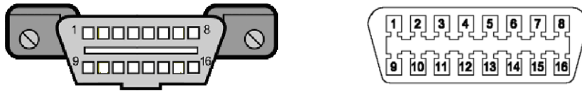
圖 12 OBD II 接頭及腳位定義圖
