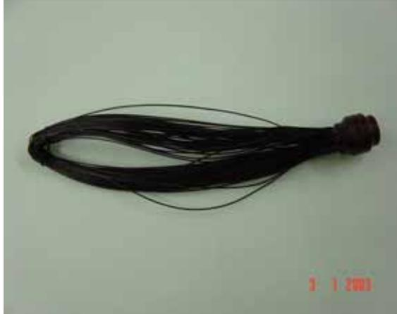
它是 Teflon fibers，每一根 fiber 像髮絲般細，可萃取油中氣體。
