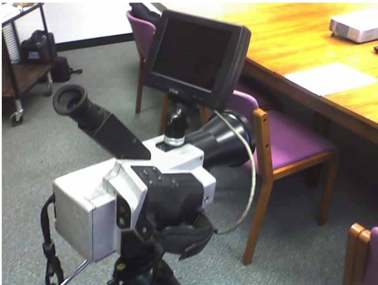
圖 2.2-1 紅外線熱影像設備：ThermaCAM PM 695, FLIR systems
