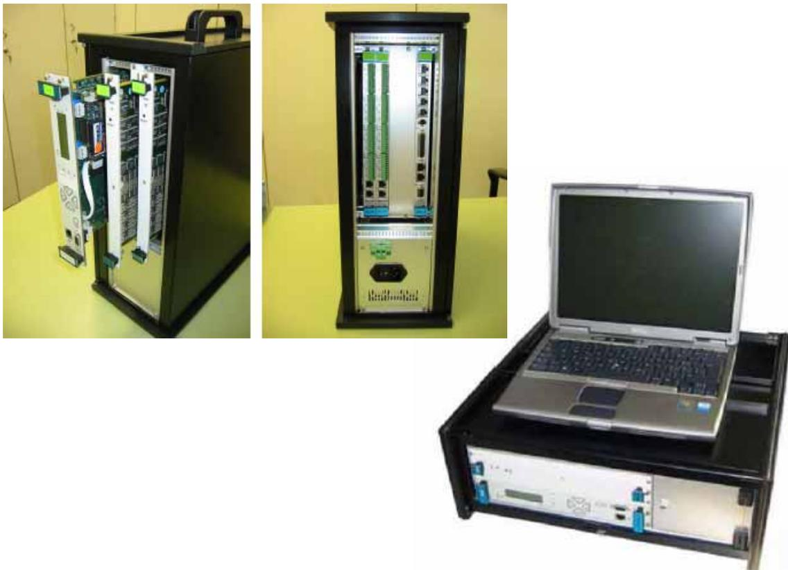
圖 9、Vibro-Meter 所開發攜帶型振動偵測診斷系統
