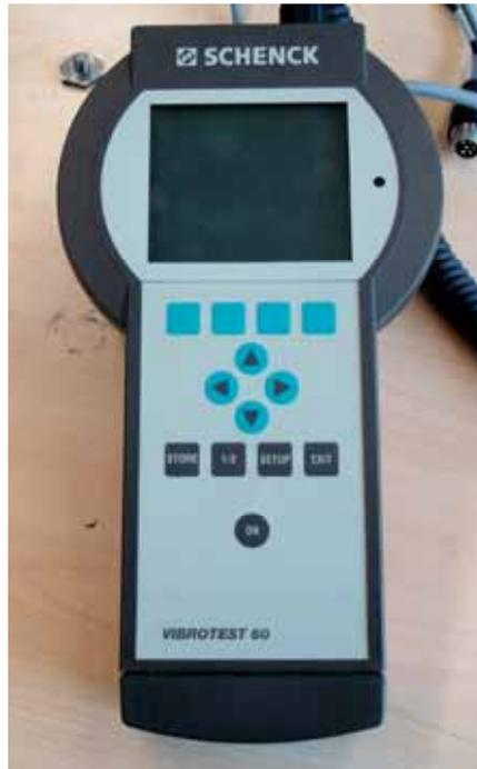
圖 6、Brüel & Kjær Vibro 所生產的掌上型測試設備
