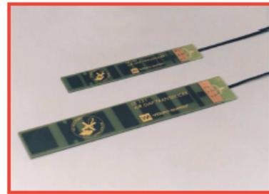
圖 21、Vibro-Meter 所製造 Air Gap 偵測器
