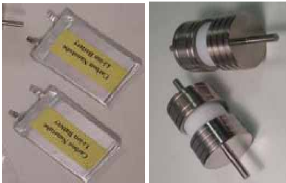
圖二十九 納米材料製作的鋰離子電池樣品
