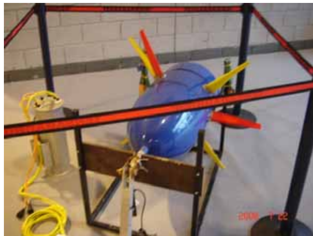
圖 5 反式旋轉潮汐渦輪機(縮小模型)
