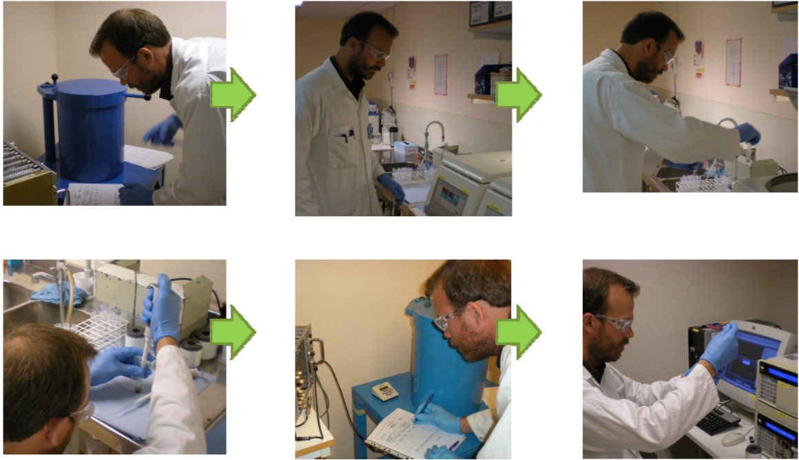
圖十一、猩猩(碳-11)放射性核醫藥物代謝產物研究：血液樣品前處理(血漿分離與蛋白質沉澱)、 gamma 活度計測與 HPLC-UV/radio-detector 分析
