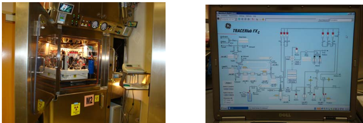
圖三、C-11 放射藥物產製鉛室及 GE TracerLab FXc 自動合成盒
