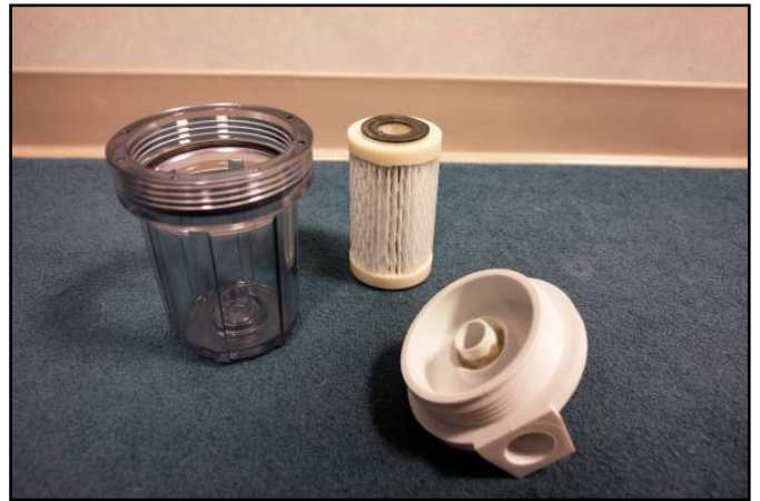
圖 19、奈米級過濾網 Nanoceram® filter 可做環境水質中生物分離及採樣用。
