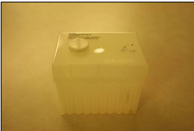
圖 26、簡單的小設計將微量吸管尖的盒子配合過濾 器，養殖蜆進行禽流感病毒監測試驗
