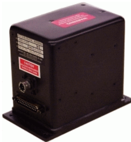
【圖 7】 機械式 AHRS
