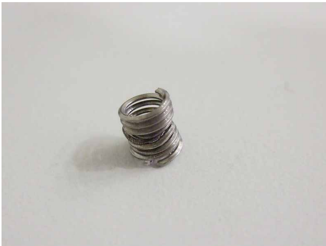
圖四十二、故障的螺紋線圈
