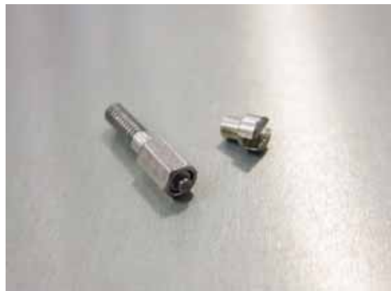
圖十八、PC1 接頭螺絲斷裂
