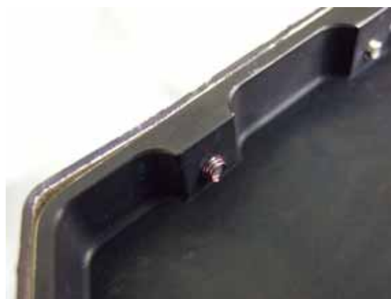
圖二十二、螺紋線圈故障二
