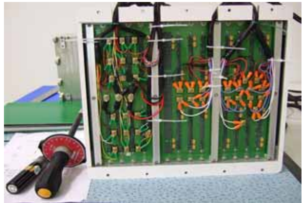
圖四、安裝 U1 最終電源接頭螺絲
