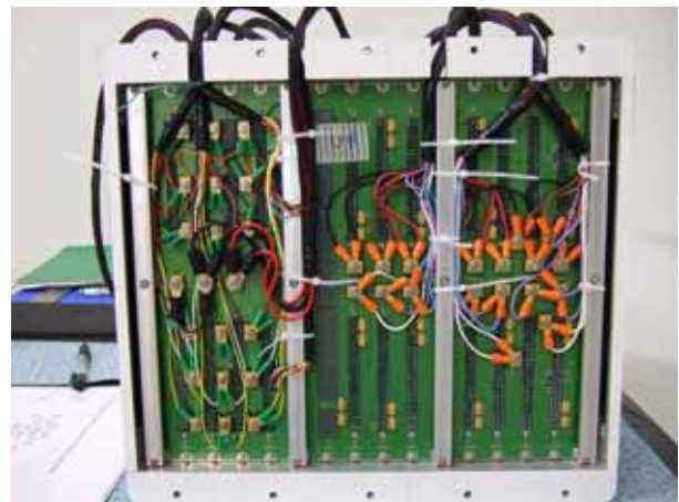
圖六、安裝 U0 最終電源接頭螺絲
