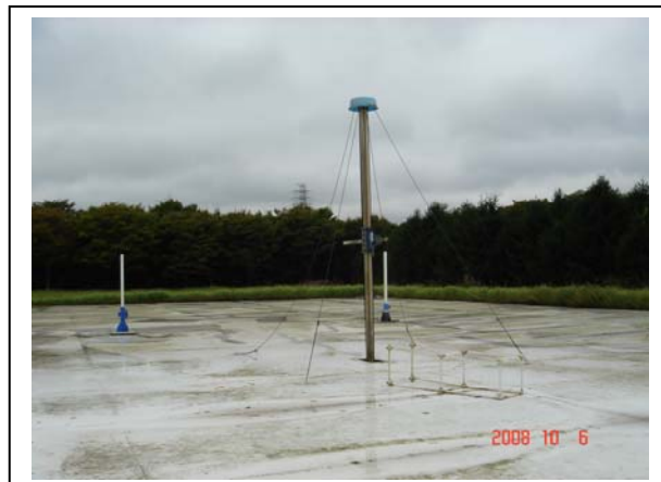
校正天線 30 MHz 到 1,000MHz 的場地 面積有 40 m × 30 m
