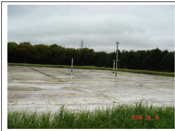
校正天線 30 MHz 到 1,000MHz 的場地 面積有 40 m × 30 m
