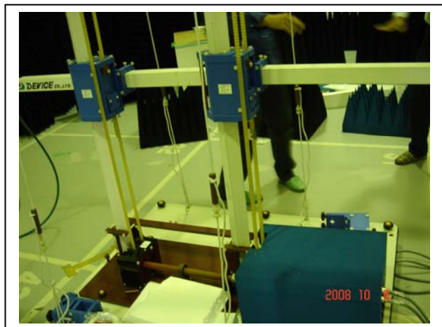
右上圖為雙軸且反射面很小的天線支架
