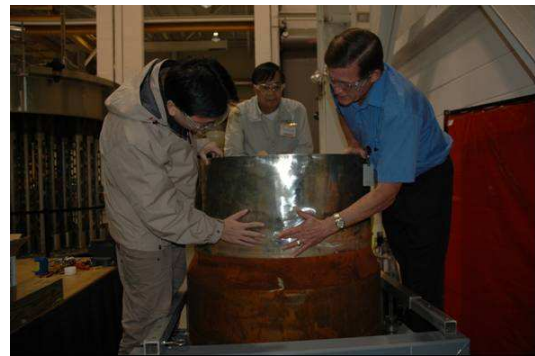
講師以異材銲接管材說明表面處理及檢測要求
