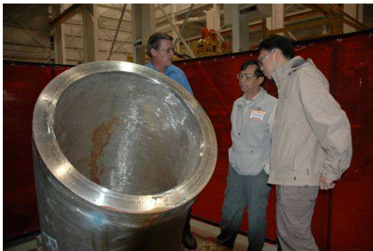
講師以厚鑄件管材說明 ASME 材料要求
